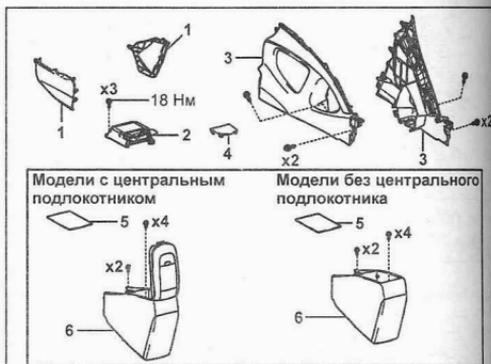
Снятие блока управления SRS (Auris). 1 - боковая отделка передней части центральной консоли №2, 2 - блок управления SRS, 3 - боковая отделка передней части центральной консоли №1, 4 - заглушка, 5 - коврик дополнительного ящика центральной консоли, 6 - дополнительный вещевой ящик центральной консоли.
